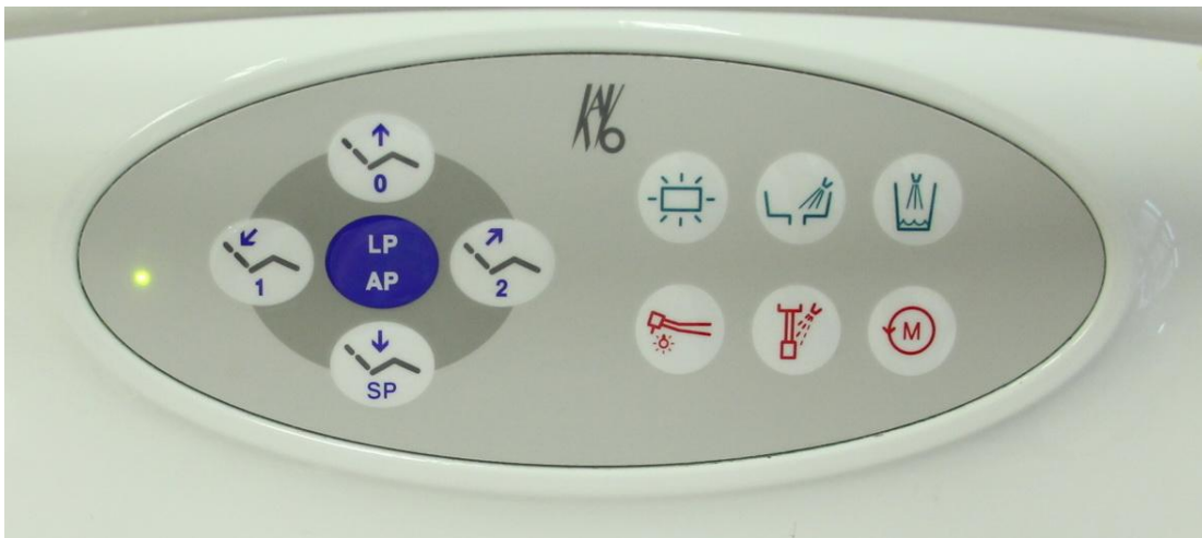
Slika 3.6: Upravljalna plošča. Tipke na levi, označene z 0, 1, 2 in SP, so za nastavljanje višine in naklona stola za pacienta, skupaj s srednjo tipko LP/AP pa za izbiranje položajev, shranjenih v spominu. Na desni strani so zgoraj tipke za vklop pregledovalnika intraoralnih slik, spiranja pljuvalnika in točenje vode v kozarec za izpiranje. V spodnji vrsti so tipke za vklop osvetlitve v glavi kolenčnika, hladilnega pršila in vrtenja v levo.
