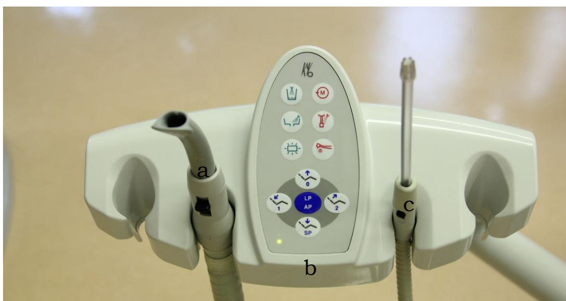
Slika 3.8: Element za asistenco: a – priključek za aspirator, b – upravljalna plošča, c – sesalnik za slino
