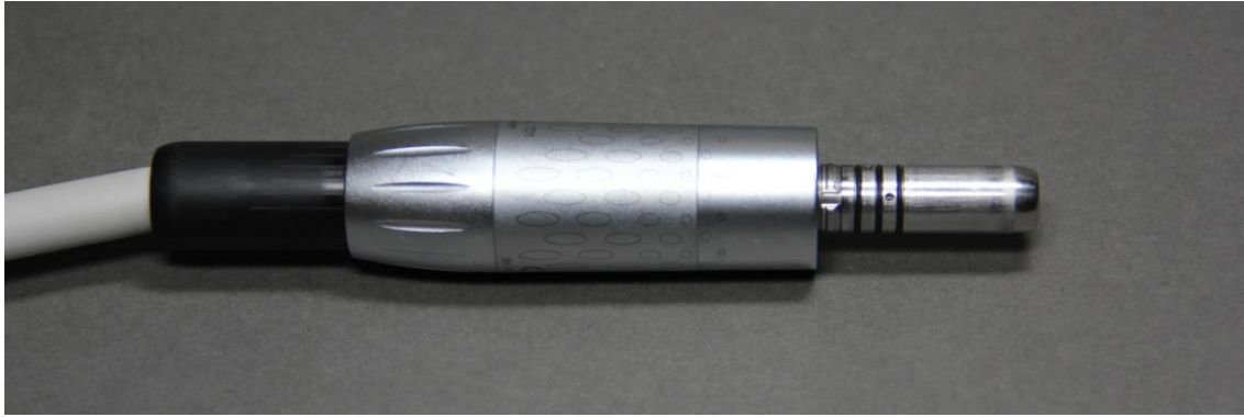
Slika 8.2: Električni mikromotor (črni obroč med cevjo in mikromotorjem je za nastavitev pretoka hladilnega pršila)
