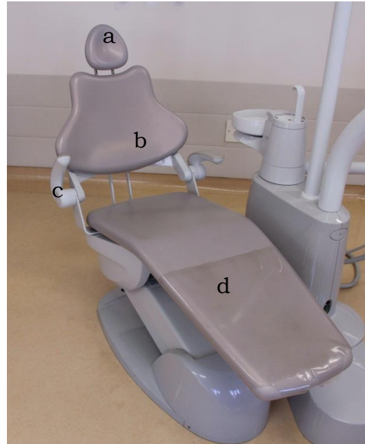
Slika 3.3: Stol za pacienta: a – vzglavnik, b – naslon za hrbet, c – naslon za roko, d – sedalni del
