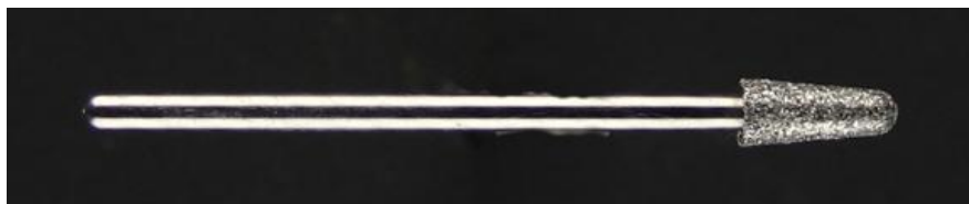
Slika 9.4: Vpenjalni del HP-svedra. Premer vpenjalnega dela je 2,35 mm, dolžina 32 mm.
