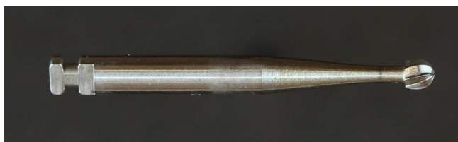
Slika 9.3: Vpenjalni del RA-svedra. Premer vpenjalnega dela je 2,35 mm in dolžina 13,2 mm, na koncu pa je utor.
