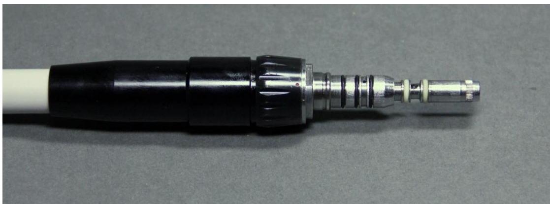
Slika 8.1: Sklopka (črni obroč z zarezi in rdečo piko je za uravnavanje pretoka vode za pršilo)
