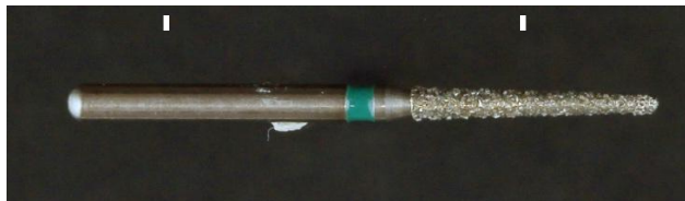
Slika 9.2: Vpenjalni del FG-svedra. Premer vpenjalnega dela je 1,6 mm in dolžina 12,7 mm.
