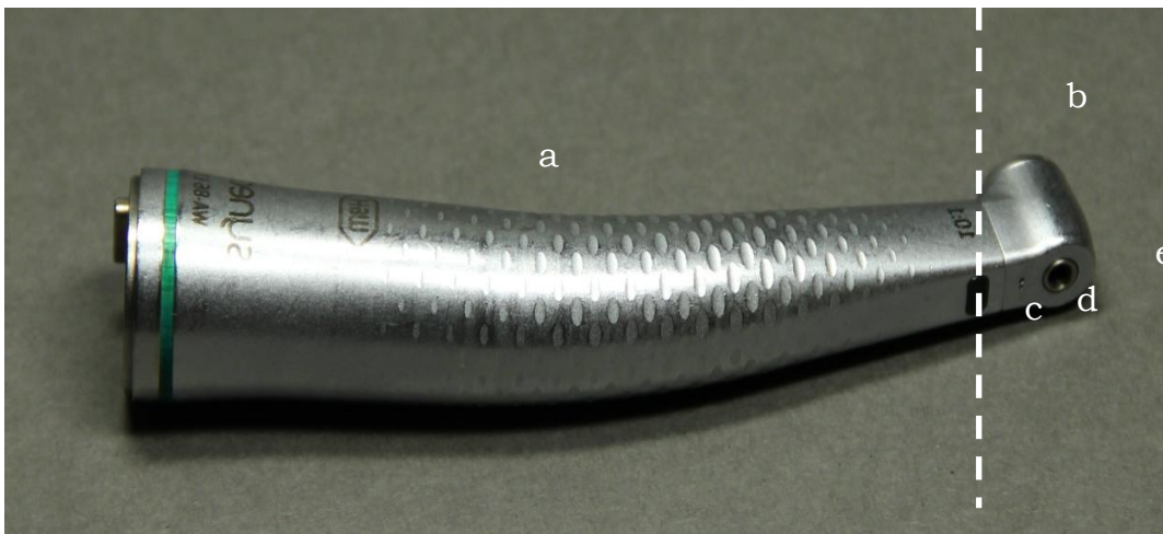
Slika 8.3: Deli kolenčnika: a – držalo, b – glava, c – optično vlakno za dovod svetlobe na delovno polje, d – luknjice za hladilno pršilo, e – odprtina za sveder
