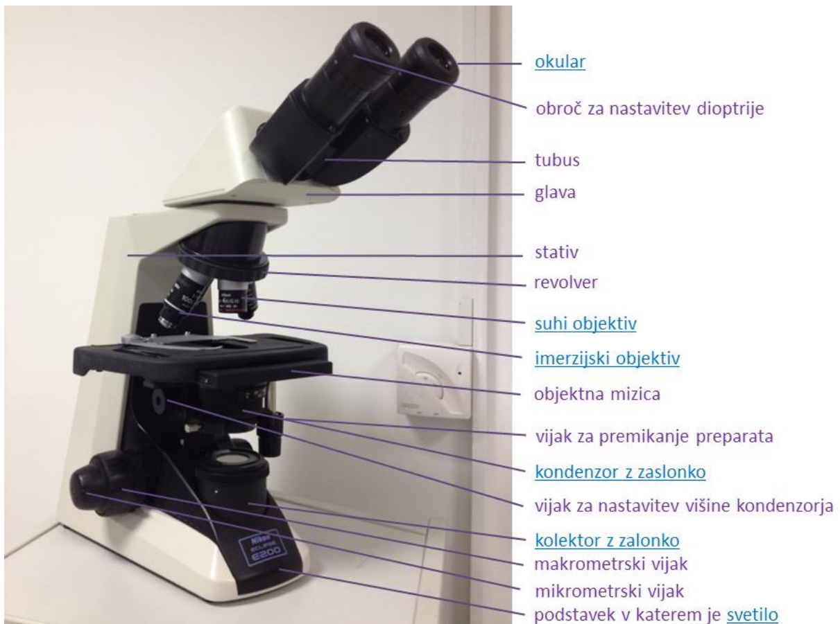
Slika 1: Klasični svetlobni mikroskop z glavnimi mehanskimi (vijolična) in optičnimi (modra) sestavnimi deli.
