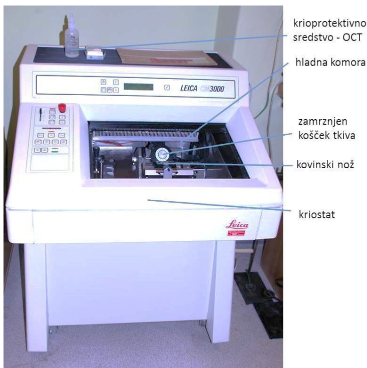
Slika 19: Kriostat, v katerem je v hladni komori kriomikrotom, je naprava za rezanje zamrznjenih rezin.
