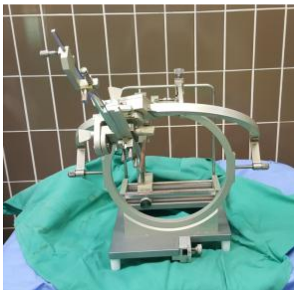
Slika 2 : Fantom z merilnimi loki za simulacijo posega pred prenosom na bolnika.
