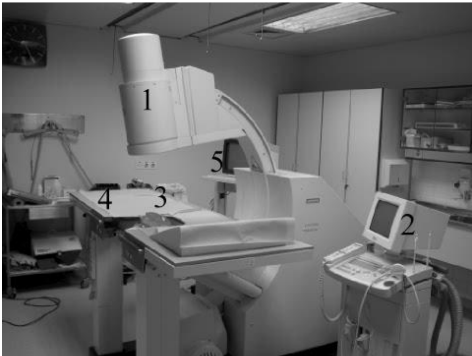
Slika 1. ESWL aparat Siemens Lithostar Multiline v prostoru KO za urologijo. S številčkami so označeni deli aparata: 1 – RTG ojačevalec 2, UZ aparat, 3 – drobilna glava, 4 – miza za bolnika, 5 – RTG monitor
